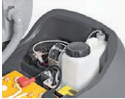
Ejemplo de motor, tanque de detergente y batería de una máquina fregadora.
