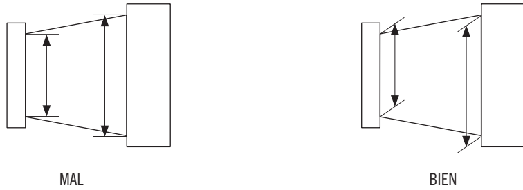
Inclinación de las líneas auxiliares de cota.
