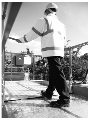
Suelo antideslizante en la plataforma de trabajo
