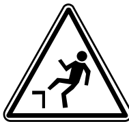
Señal de riesgo de caída a distinto nivel
