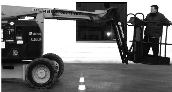
Operador de plataforma elevadora abrigado
