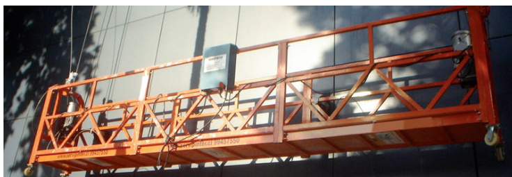
Plataforma eléctrica para trabajos en altura
