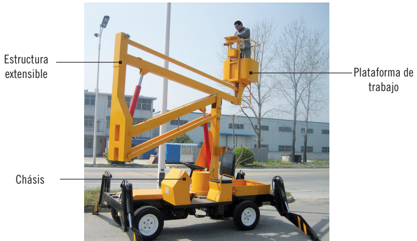
Partes de una plataforma elevadora
