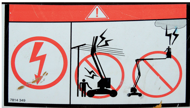
Indicaciones de advertencia en la carcasa del chasis: Peligro de descarga si se trabaja cerca de líneas eléctricas o de nubes que pueden generar rayos.
