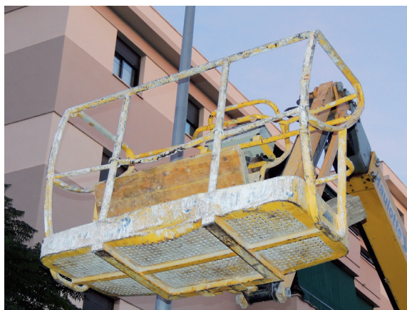
La plataforma de trabajo de la imagen tiene suciedad.
