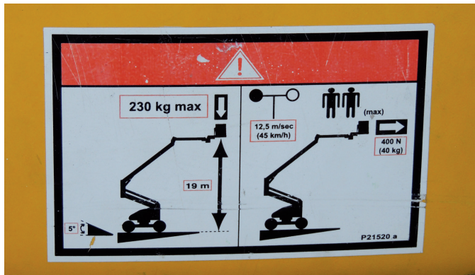
Señales de advertencia-prohibición en el chasis
