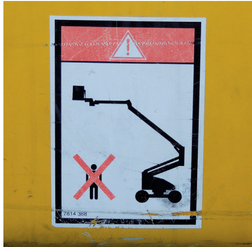
Señal de advertencia-prohibición en el chasis: no puede haber nadie debajo de la plataforma de trabajo ni en el radio de acción de la estructura extensible.
