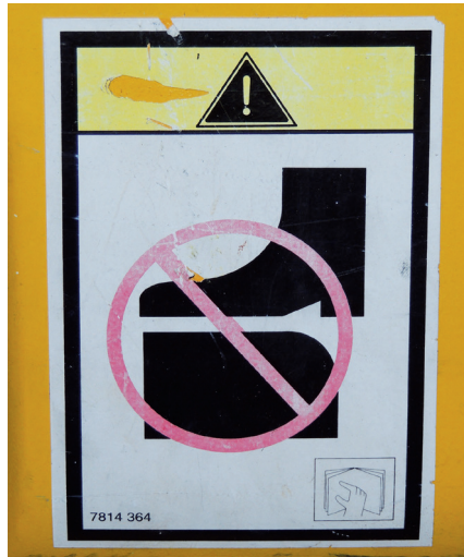
Señal de prohibición en el chasis: prohibido utilizar cualquier calzado en la plataforma de trabajo
