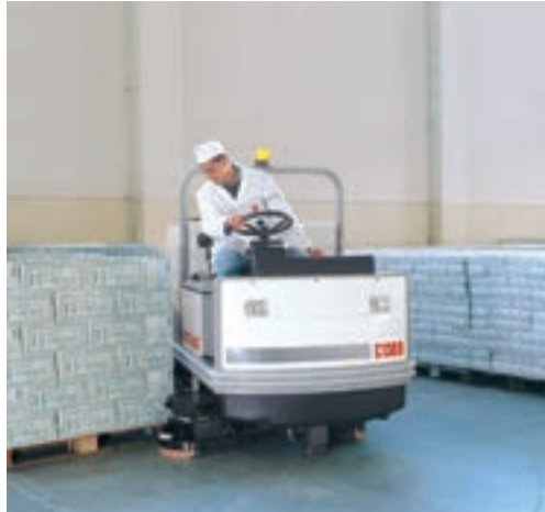
Limpieza por fregadoras automáticas
