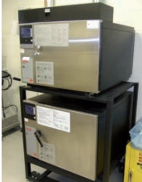
Cámara de óxido de etileno
