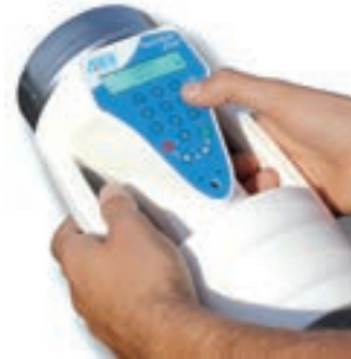
Muestreador de aire que contiene en su interior una placa con medio de cultivo
