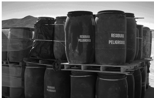
Ejemplo de residuos peligrosos (RP) debidamente almacenados
