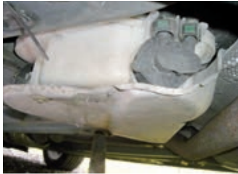
Depósito de aditivo
