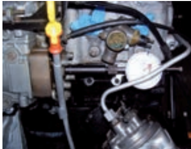
Medición de la carrera del émbolo con comparador
