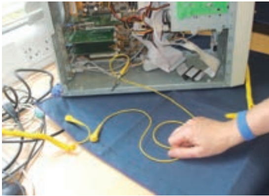
Operación de reparación de un PC con pulsera antiestática colocada en la muñeca
