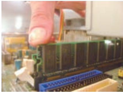
Insertando módulo de RAM en placa base
