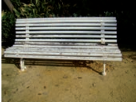
Banco de listones de madera sobre unas patas de hierro fundido
