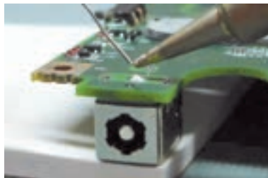
Soldando una pista de un circuito impreso
