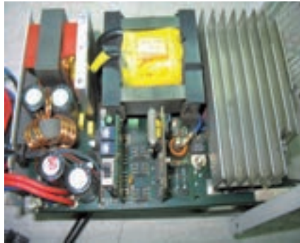
Interior de fuente de alimentación
