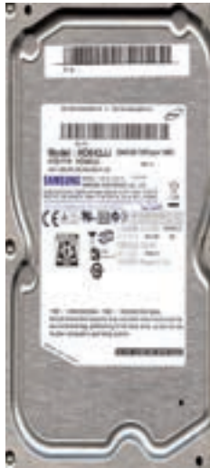
Especificaciones en la etiqueta de disco duro ATA
