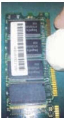
Borrando con una goma los conectores del módulo
